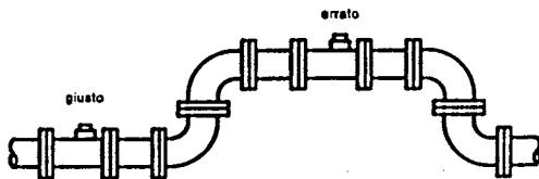
Poiché il contatore deve essere sempre pieno d' acqua, bisogna prevedere l' installazione nella posizione inferiore dell' impianto.
