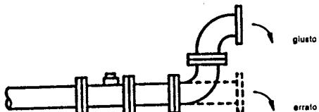
Il contatore deve essere installato ad un livello inferiore rispetto allo scarico. In questo modo non si avranno ingressi d'aria.
